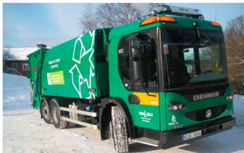
Vår nya dual fuel-lastbil, som kombinerar metangas och diesel som drivmedel.
